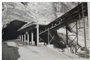
Convoyeur à bande extrayant le gypse de la carrière de la combes Source: Musée du plâtre
